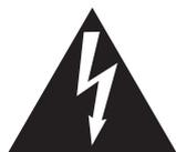
Символ молнии со стрелочкой в равнобедренном треугольнике предупреждает пользователя о наличии незащищенного высокого напряжения в устройстве. Это может стать причиной удара током.
